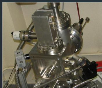
Un prototype Orbitrap de laboratoire est opérationnel au LPC2E, à Orléans. Il est utilisé pour mesurer les performances accessibles, définir et valider les spécifications d'un instrument spatial embarqué. Le principe instrumental est un LDI-MS (Laser desorption ionisation - mass spectrometry).
