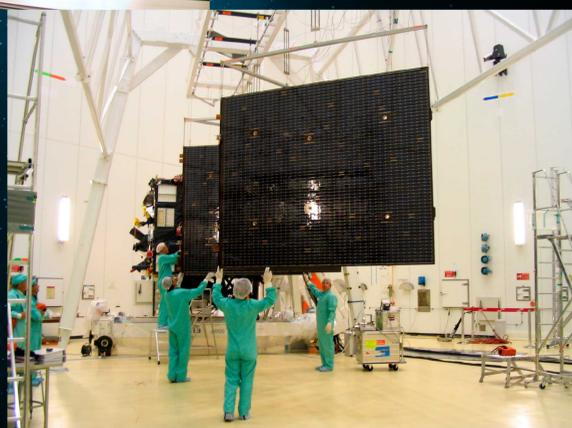
Test de déploiement des panneaux solaires de Rosetta.
